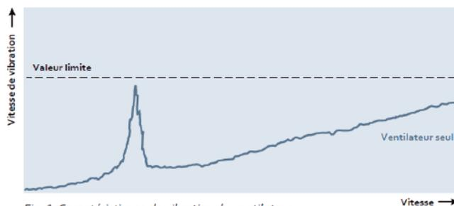
Fig. 1: Caractéristiques de vibration du ventilateur
